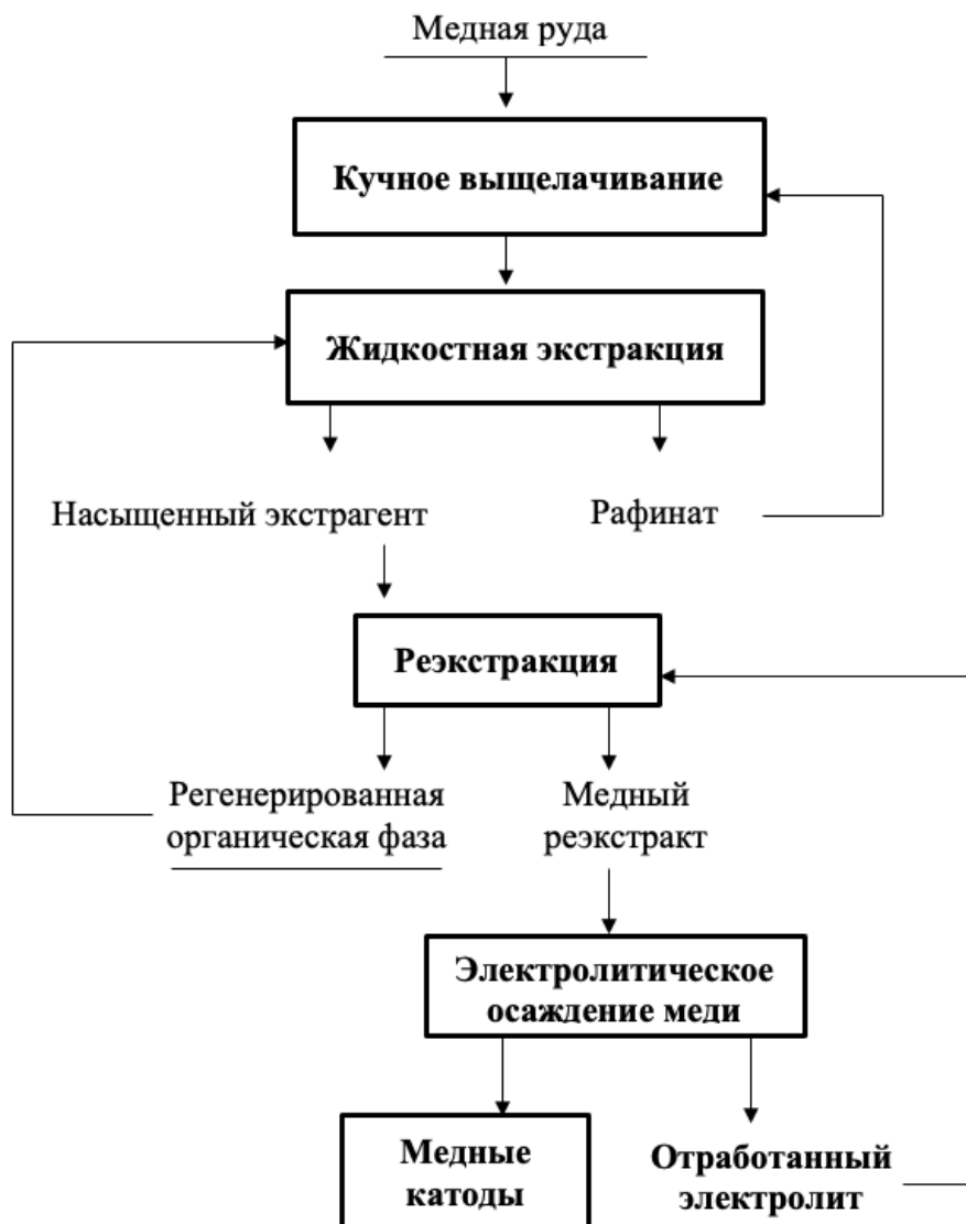
Рисунок 2 – Схема экстракционного извлечения меди
