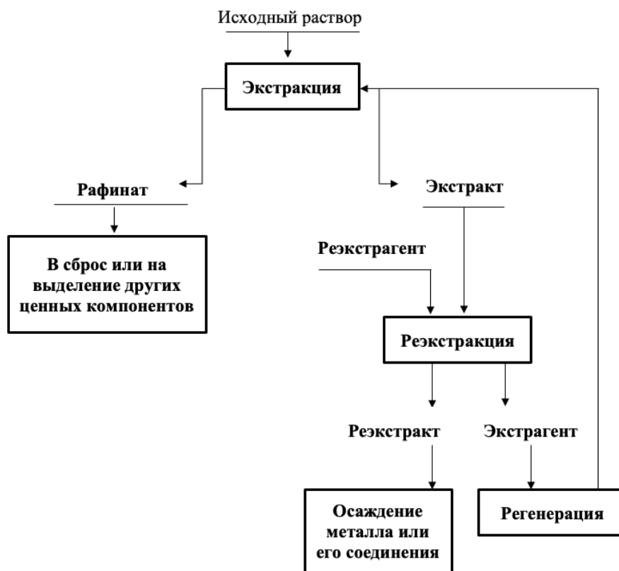
Рисунок 1 – Принципиальная схема экстракционного извлечения металла из раствора
